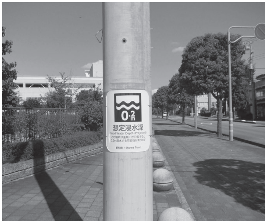
想定浸水深表示板
