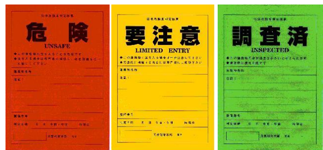
〈応急危険度判定のステッカー(全国被災建築物応急危険度判定協議会ホームページより)〉
